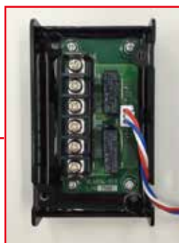
外部出力基板
